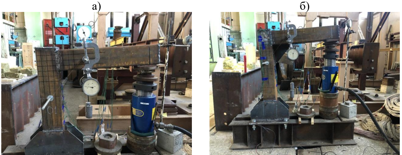
Рисунок 9 – Испытанные образцы узлов: а) без ребра; б) с ребром жесткости
