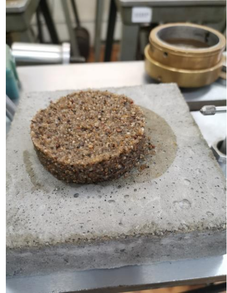
Рисунок 8 — Модернизированный прибор «Гидропроекта» ПСГ-3М: а) общий вид прибора, подготовленного к испытаниям; б) образец грунта после проведения испытания
