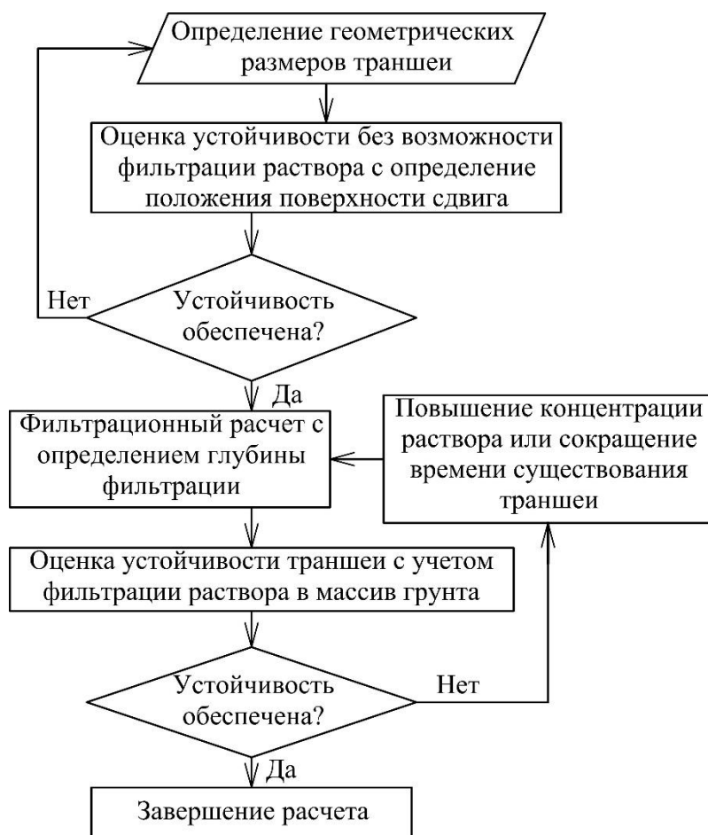
Рисунок 11 — Блок схема к расчету устойчивости траншеи с возможностью фильтрации раствора из нее
