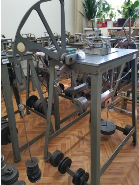
Рисунок 8 — Модернизированный прибор «Гидропроекта» ПСГ-3М: а) общий вид прибора, подготовленного к испытаниям; б) образец грунта после проведения испытания
