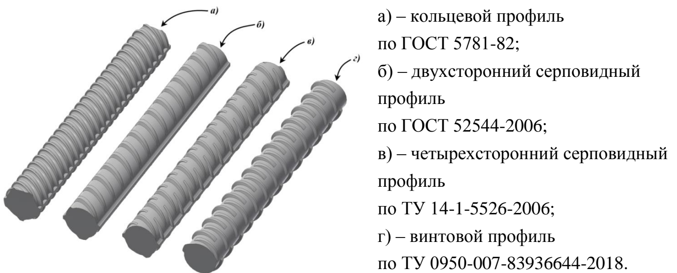
Рисунок 1 – Общий вид арматуры с различными видами периодического профиля.
