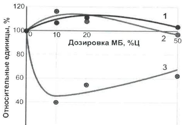
Рисунок 17 – Изменение прочности, модуля упругости и меры ползучести высокопрочного мелкозернистого бетона в зависимости от качества цементного камня (дозировки МБ)
