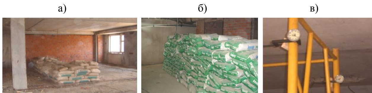
Рисунок 3 – Поэтапное нагружение (а, б); измерение прогибов плит (в)
