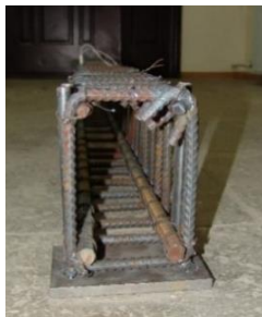
Рисунок 2 – Общий вид арматурных каркасов балок групп Б1, Б2, Б7
