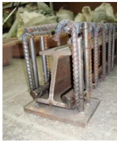
Рисунок 1 – Общий вид жесткой и гибкой арматуры балок групп Б4, Б5
