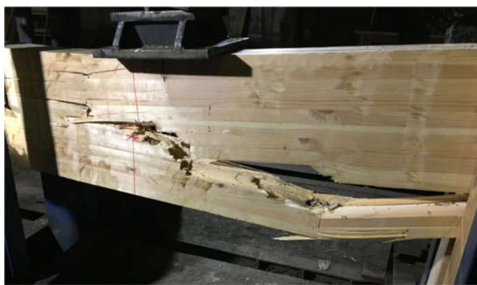
Рисунок 10 – Разрушение армированной балки
