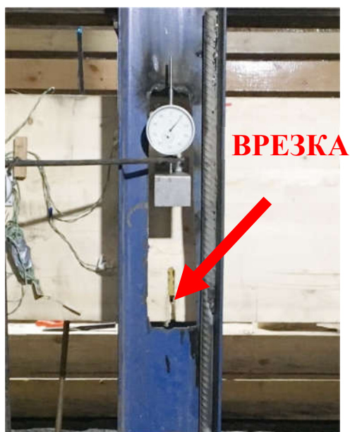
Рисунок 14 – Участок конструкции с искусственным дефектом
