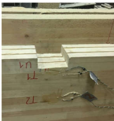
Рисунок 11 – Усиление балки в зоне дефекта
