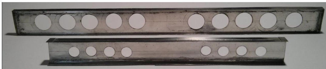
Рисунок 6 – Конструкции моделей перфорированных балок:
