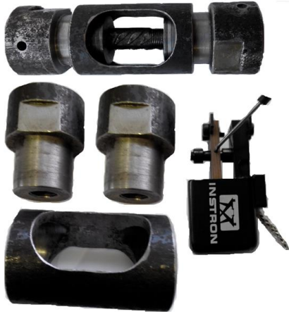
Рисунок 1 – Образец арматуры для испытания на сжатие и элементы оснастки
