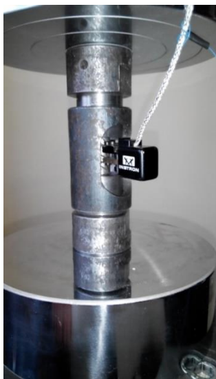
Рисунок 3 – Испытание на сжатие
