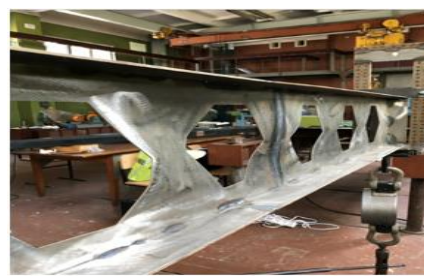
Рисунок 16 – Испытание балки Б-0.4: а) схема расположения одного из индикаторов; б) общий вид потери устойчивости перемычек
