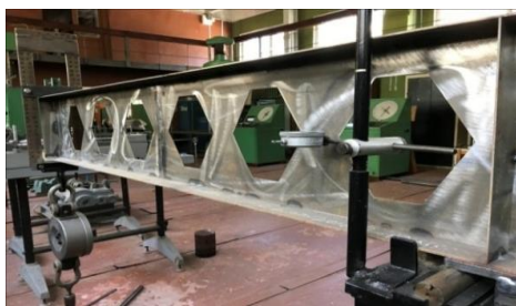
Рисунок 16 – Испытание балки Б-0.4: а) схема расположения одного из индикаторов; б) общий вид потери устойчивости перемычек
