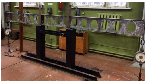
Рисунок 15 – Установка для испытания на устойчивость балок с ромбовидной перфорацией
