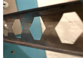
Рисунок 17 – Испытание модели балок с ромбовидными вырезами из жести: а) нагружение сосредоточенной силой; б) потеря устойчивости перемычек.
