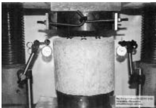
Рис. 2. Обетонированный узел стыкового соединения подготовлен к испытанию сжимающей нагрузкой
